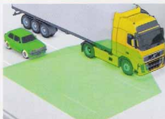
Το «Turn-off assistant» δίνει στον οδηγό την εικόνα της δεξιάς πλευράς της καμπίνας του, αλλά και αυτή ακριβώς μπροστά του.
