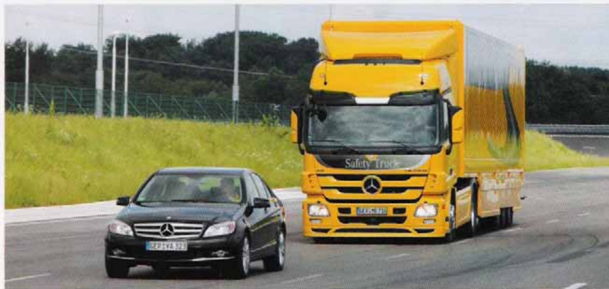
Σε περίπτωση που ο οδηγός δεν αντιδράσει εγκαίρως, το Advanced Emergency Braking System αυτόματα ενεργοποιεί τα φρένα κατά 30%, ενώ επεμβαίνει μέχρι και στο 100%, αν ο οδηγός δεν αντιδράσει καθόλου.
